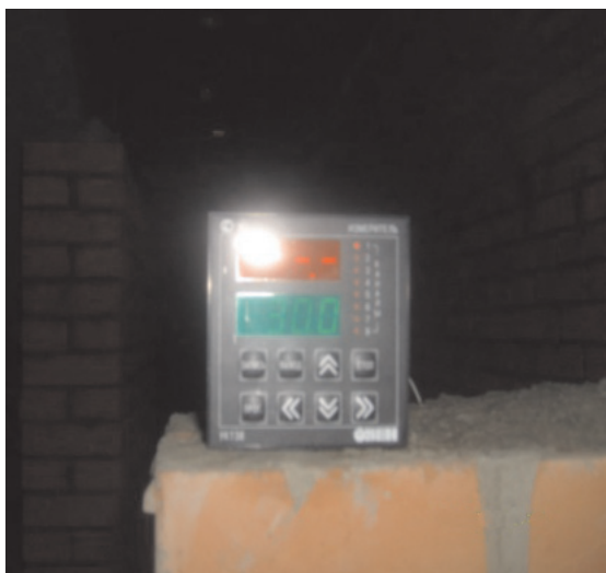
Рис. 2. Устройство для определения температуры обогреваемого бетона
