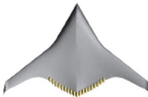
Рис. 2. Распределенная силовая установка с множеством газогенераторов
