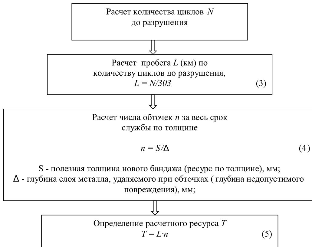
Рис. 3. Алгоритм расчета ресурса бандажа локомотивного колеса
