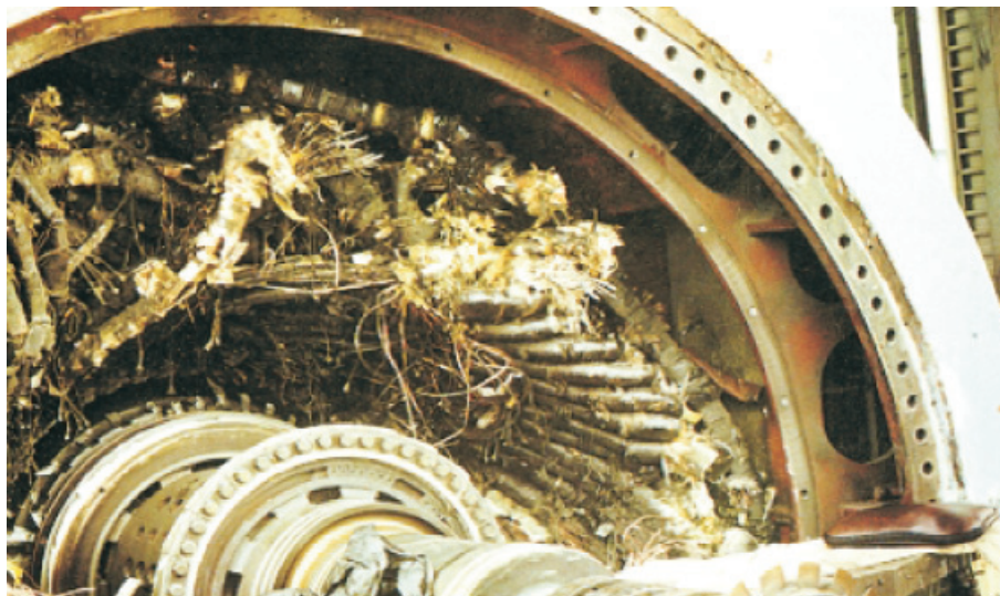
Рис. 2. Последствия разрушения бандажного кольца
